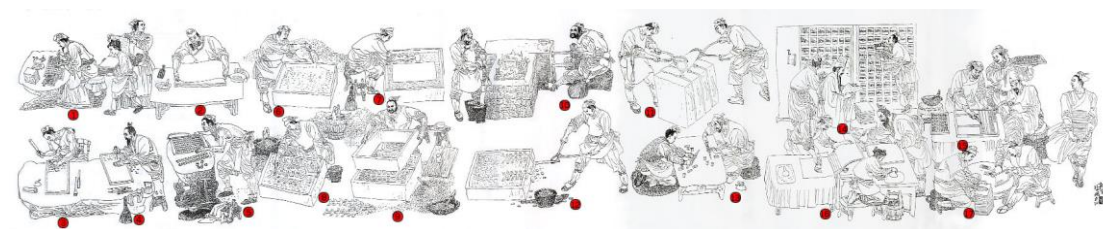
中国传统金属活字印刷工艺流程图
